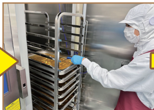
出来たカレーはすぐに 急速冷却機で冷やします
